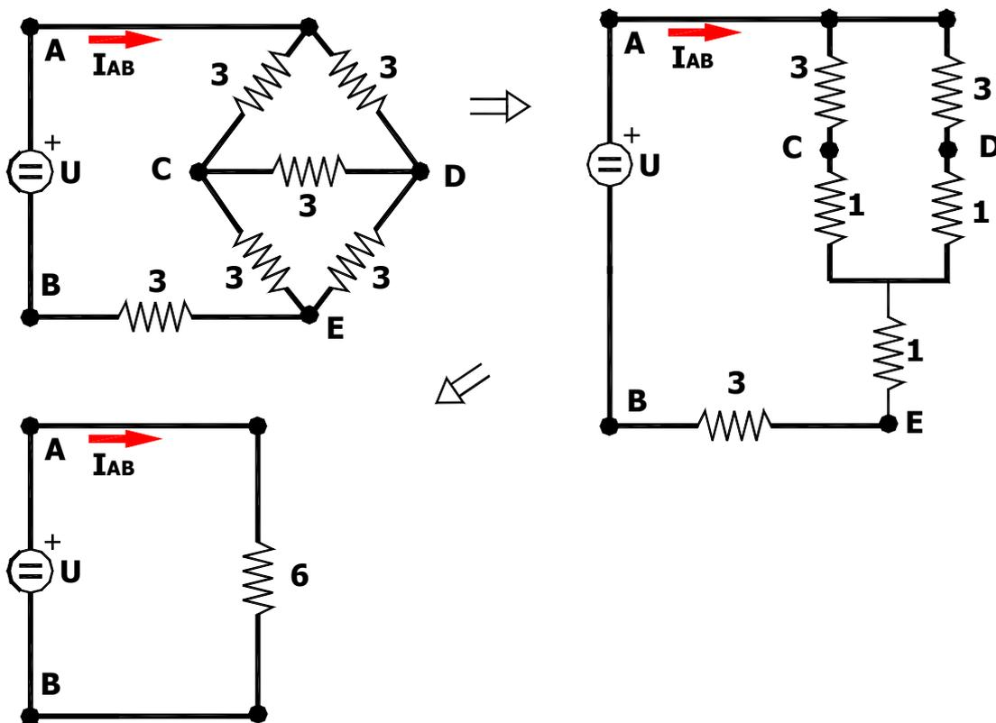
El triángulo existente entre los puntos CDE se ha convertido en una estrella. Como los valores de las resistencias del triángulo son iguales, los valores de la resistencia de la estrella serán iguales y de valor:
